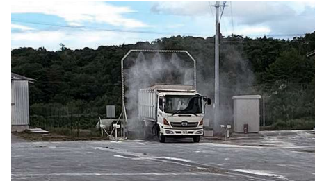
③ 共同利用施設へ入るときは、車両を消毒しましょう。
